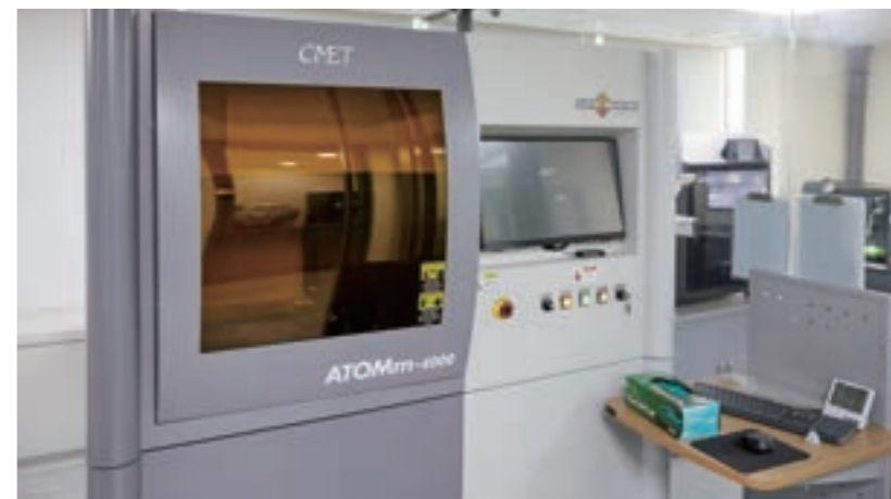
광경화성 수지 조형(SLA) 방식의 3D프린터 'ATOMm-4000'
