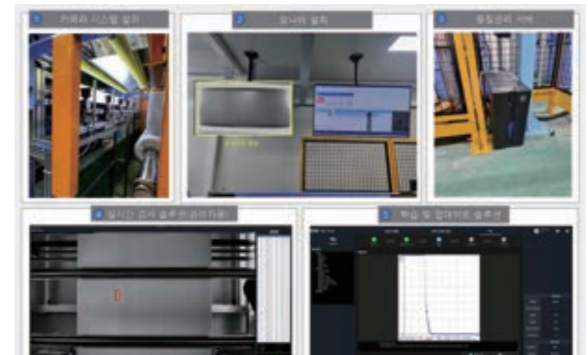
BOM Inspection 시스템을 통한 스틸 표면 검사 수행 모습
